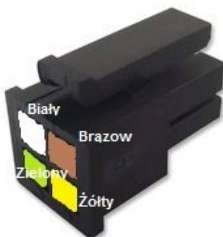
Ilustracja 1: Wyprowadzenia wtyczki przewodu do panelu CDI 4.3"
