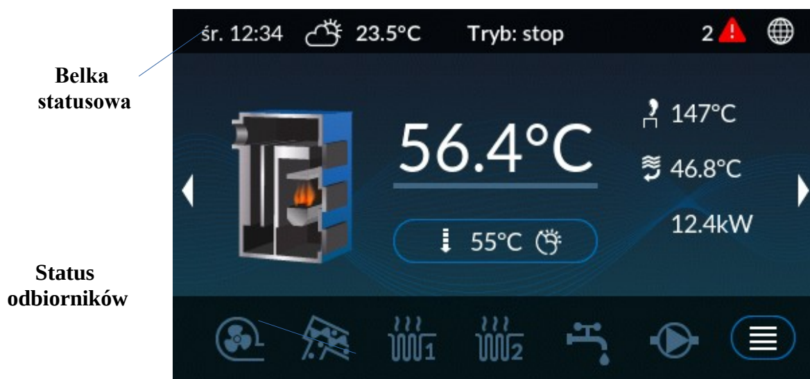
Ilustracja 10: Ekran główny, ekran kotła C.O.
